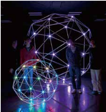
図3 作製したライティングドームの例（大型：直径2.8mと中型：直径1.1m）。今回の展示は直径1mで白色のみの照明。
