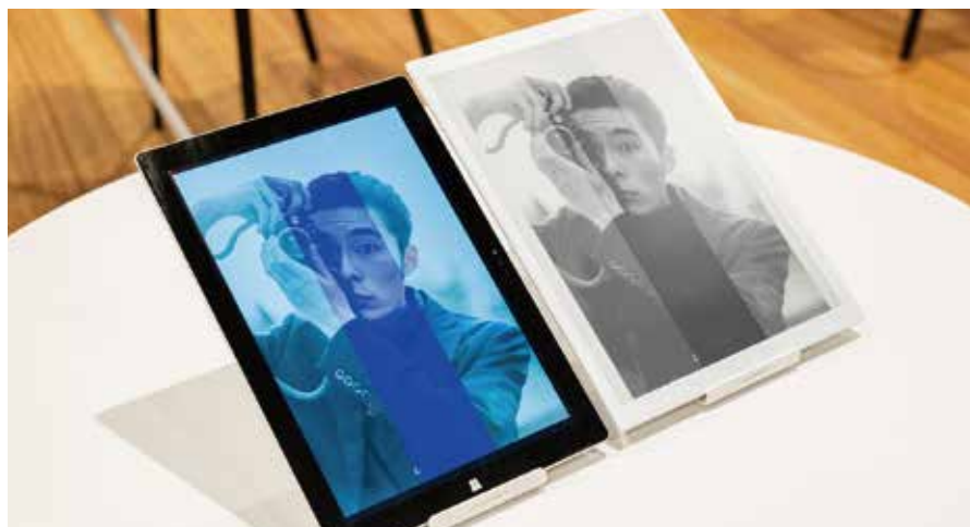
図1 バックライト付き液晶モニタ(左)と電子ペーパー(右)
