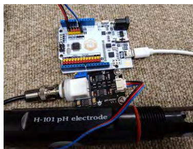
Fig. 4 pHセンサーを接続した Arduino Uno
